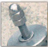
L'axe centre (tige filetée) doit garder un espace suffisant entre le champignon et l'arrêt de la tige, entre 3 et 5 cm max, position au repos.
