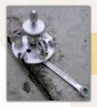
Le tampon utilisé doit pourvoir retenir le poids de la carotte. L'axe centre (tige filetée) doit être bloqué sur la pièce à retenir par le contre-écrou ou similaire.
